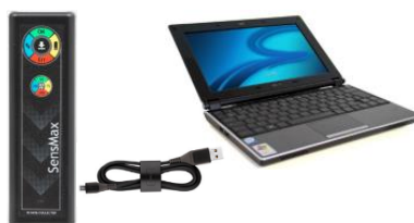
Z datového sběrače přes místní síť, Wifi nebo GPRS do webové aplikace
